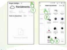
Conecte la cámara a la corriente y espere un momento, presione el botón de reinicio por 5 segundos, escuchará "restore factory settings", luego "camera start", confirme que el dispositivo emita un tono, posteriormente escuchará "please config network". Haga clic en "Siguiente" (4). Introduzca la información de su red WiFi y la contraseña de la misma, luego haga clic en "Siguiente" (5).
