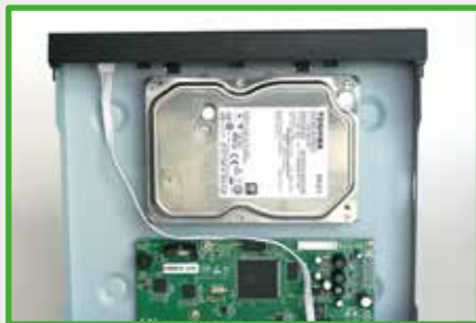
2.- Coloque el disco duro
