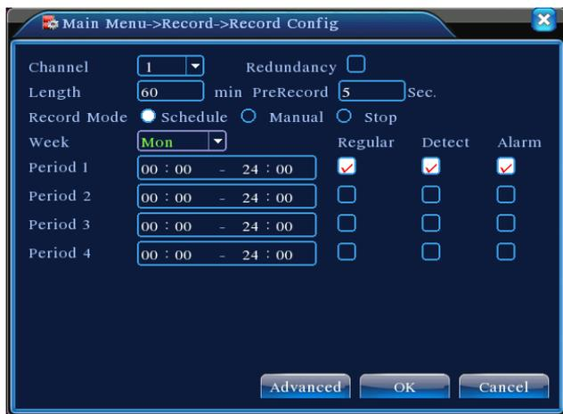
Fig 2 Configuración de grabación
